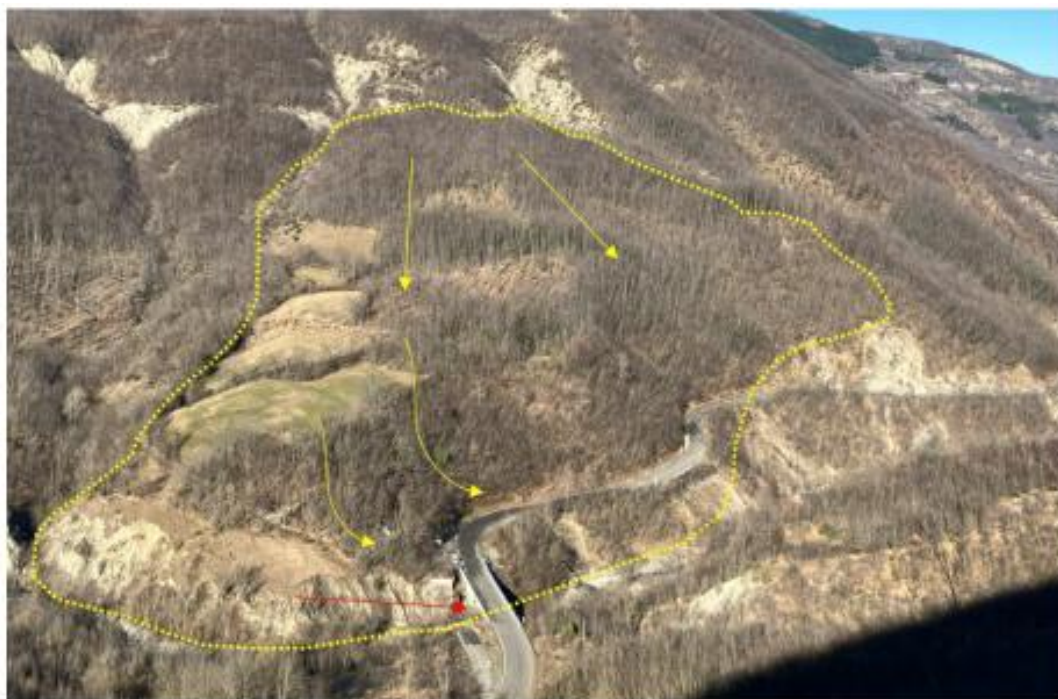
Visione d'insieme del vasto accumulo di frana. Le frecce gialle indicano la probabile direzione di movimento mentre quella rossa l'immersione a franapoggio del substrato roccioso
