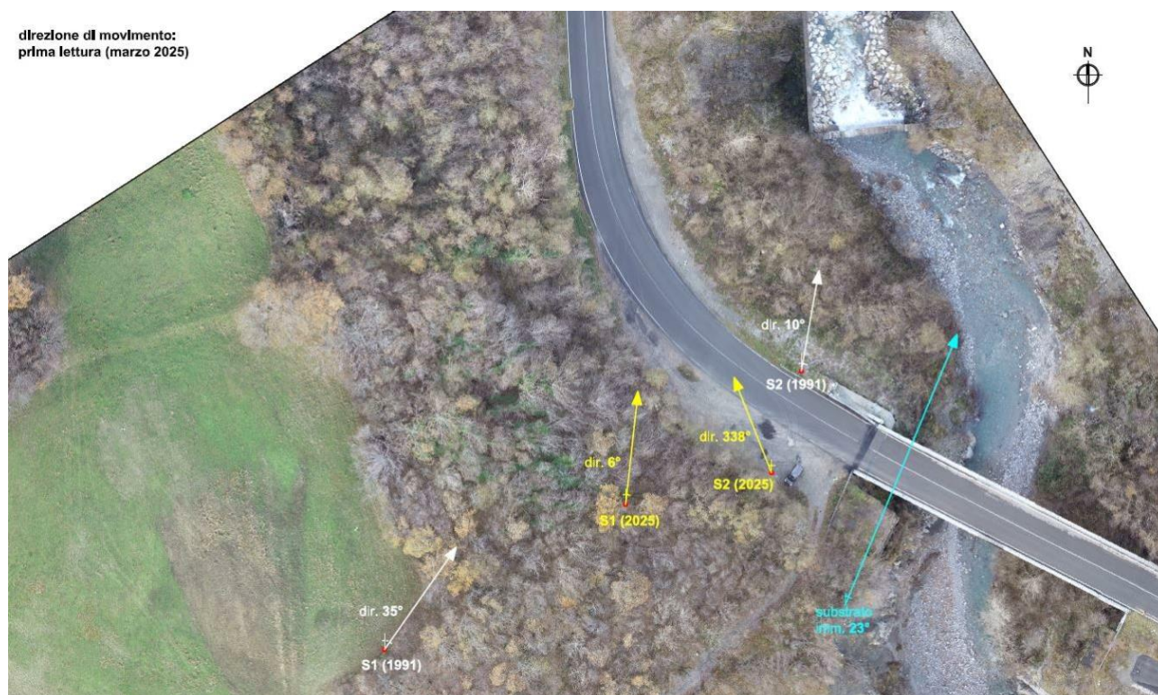
Indicazioni direzione dei movimenti dalle letture degli inclinometri
