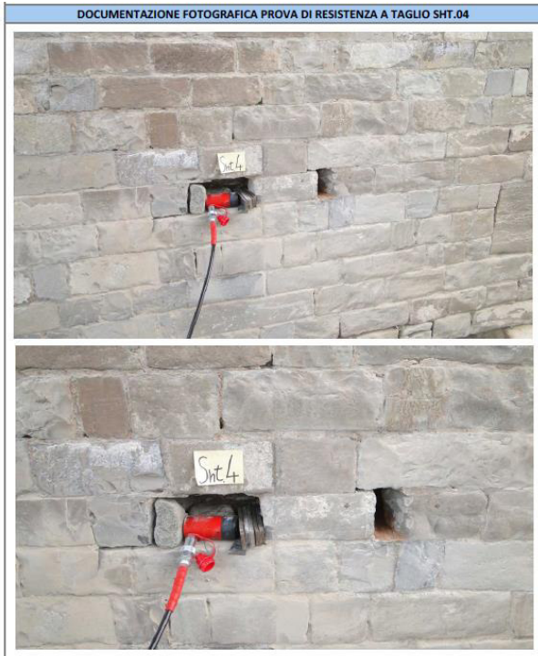
Risultati prova di taglio diretto n°4
