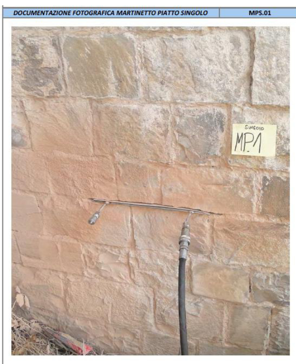
Risultati prova n°1 con singolo martinetto piatto
