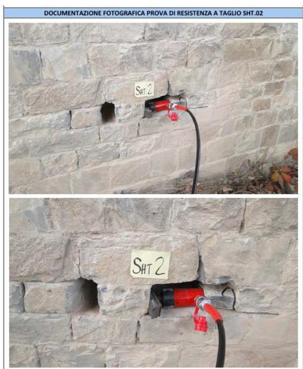
Risultati prova di taglio diretto n°2
