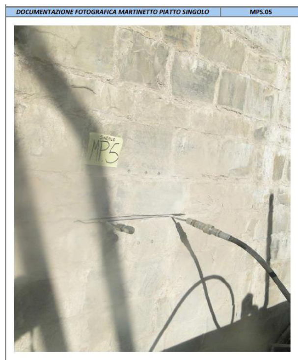
Risultati prova n°5 con singolo martinetto piatto
