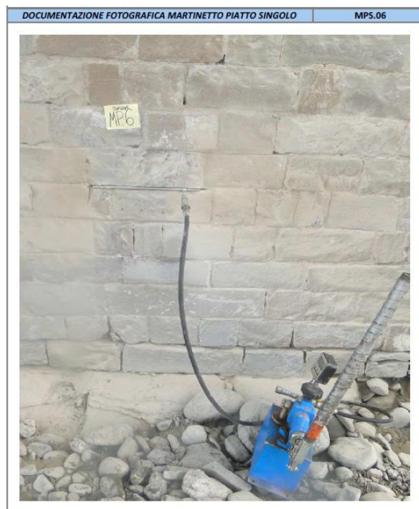
Risultati prova n°6 con singolo martinetto piatto
