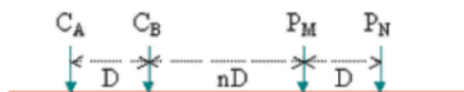
[Figura n. 12 – CA, CB (elettrodi di corrente); PM, PN (elettrodi di potenziali), D equispaziatura, n fattore incrementale della spaziatura in relazione al livello di profondità]
