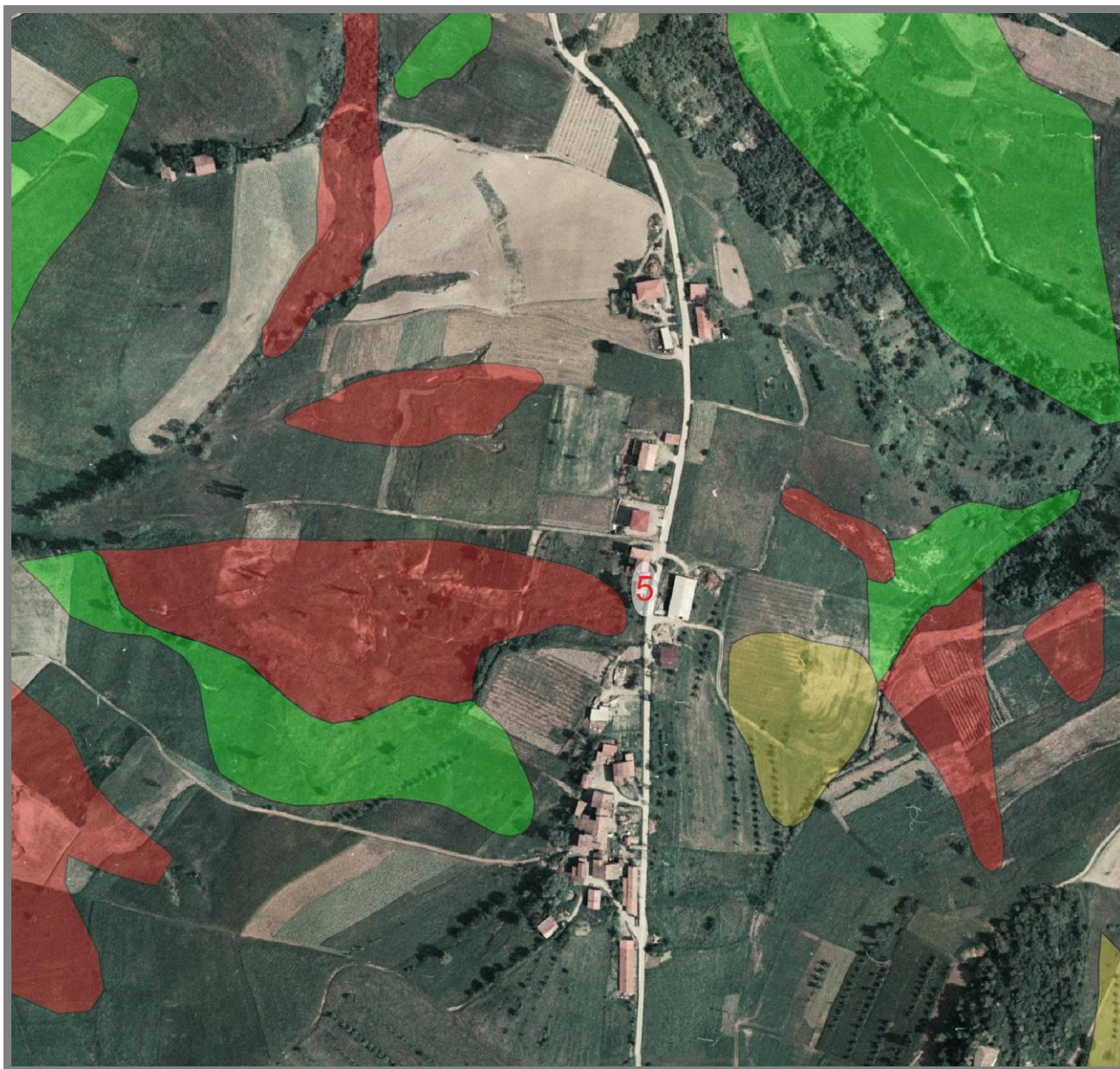
Fig. 4.2 - Area n. 5: estratto carta inventario delle frane RER ed. 2021 (base Ortofoto RER 1976-1978) - In rosso: depositi di frana attiva; in verde: depositi di frana quiescente; in giallo: depositi di versante s.l.
