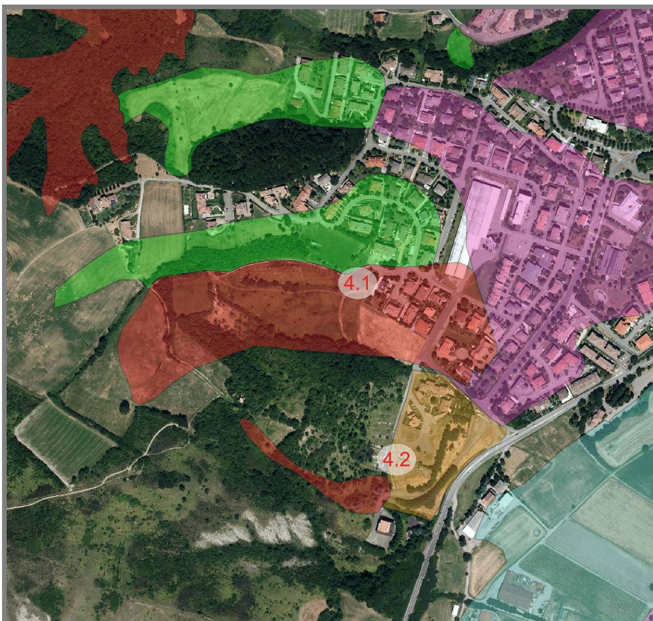
Fig. 5.1 - Aree n. 4.1 e 4.2: estratto carta inventario delle frane RER ed. 2021 (base Ortofoto Agea 2020) - In rosso: depositi di frana attiva; in verde: depositi di frana quiescente; in arancio: deposito antropico; in viola: AES7b Unità di Vignola
