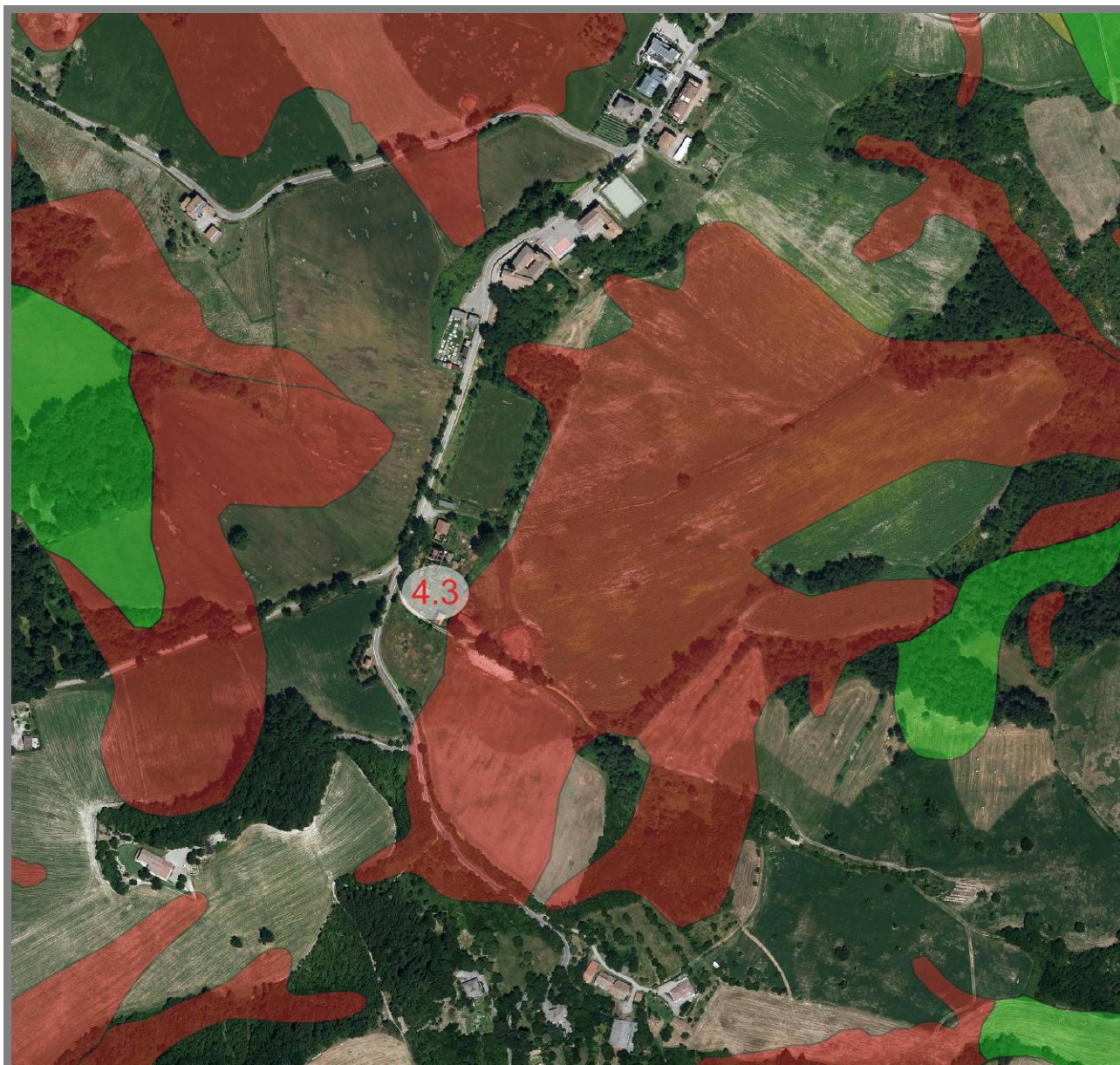
Fig. 2.4 - Area n. 4.3: estratto carta inventario delle frane RER ed. 2021(base Ortofoto Agea 2020) - In rosso: depositi di frana attiva; in verde: depositi di frana quiescente
